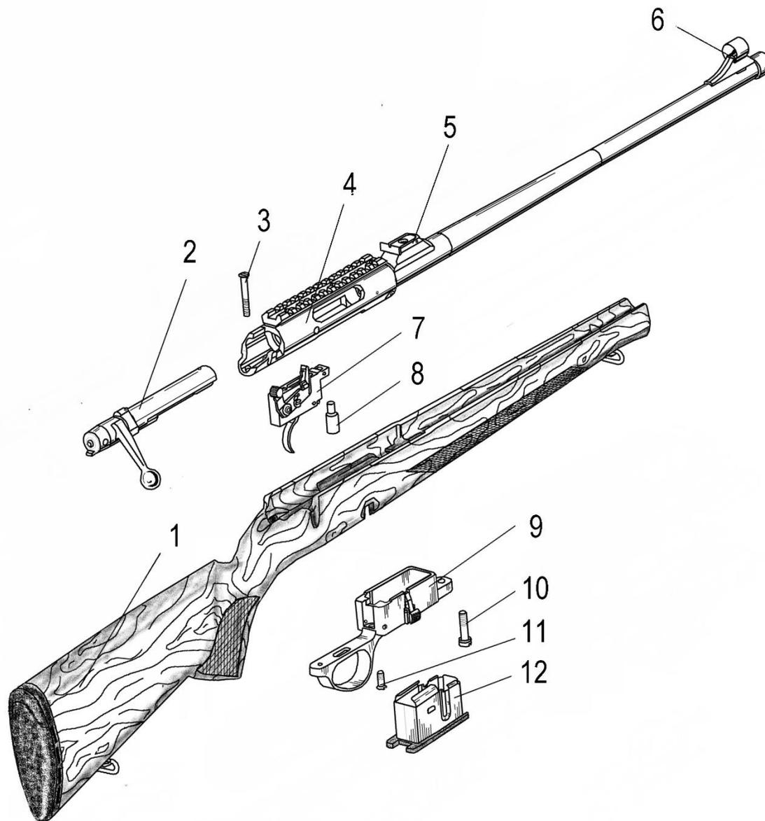
1 – ложа ВПО-193.06.00, -01; 2 – затвор ВПО-193.02.00; 3 – винт задний ВПО-193.00.03; 4 – коробка ствольная со стволом ВПО-192.01.10; 5 – целик ВПО-105.01.06; 6 – мушка ВПО-105.01.03; 7 – механизм спусковой ВПО-193.03.00; 8 – винт опорный ВПО-193.00.01; 9 – приемник магазина ВПО-193.04.00; 10 – винт передний ВПО-193.00.02; 11 – винт средний ВПО-193.00.04; 12 – магазин ВПО-193.05.00.
